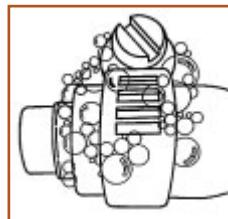
Μπορείτε να ελέγχετε την σύνδεση υγραερίου με την δοκιμή των φυσαλίδων. Είναι ένας πολύ αποτελεσματικός τρόπος, όταν χρησιμοποιείστε σαπουνόνερο.
